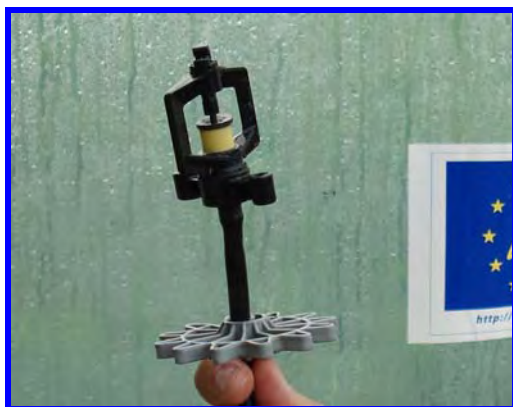
Particolare del diffusore dinamico
