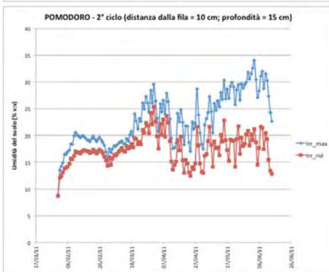
Figura 17 – Pomodoro 2° ciclo. Influenza della gestione dell'irrigazione sui profili di umidità del terreno, misurata con sonde FDR.
